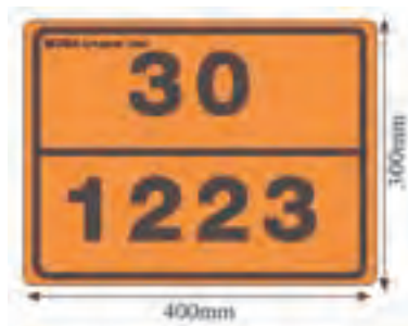
شکل ۱۱- تابلوی ثابت مخصوص نمایش شماره شناسایی و شماره بین‌المللی
