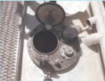
شکل ۲۱- بازرسی دریچه آدمرو قبل از انجام عملیات بارگیری
