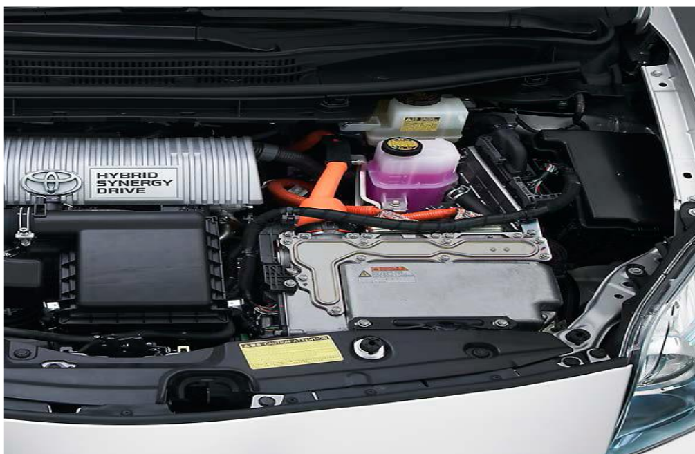
علامت هیبرید (HYBRID) و سیم‌کشی نارنجی رنگ در موتور خودرو
